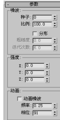
图 4.31 “噪波”修改器的参数面板
